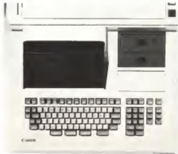
**Canon Ward 88.** Un sistema completo destinato per ora al solo mercato interno ed orientato verso il text processing, una tipica applicazione "di ufficio". Tastiera, microfloppy, stampante, video a fusione verde da 40 caratteri per 16 righe, possibilità di scrivere non solo in Katakana ma anche in Hiragana, l'ideale per uso commerciale
